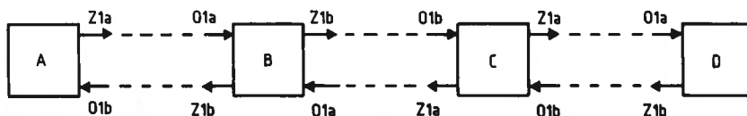
fig. 4.93. Kanaalindeling doorgaande keten. Situatie voor kanaal 1.
